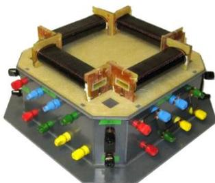
Neben Norm-Messungen bis 6 kHz sind auch Messungen mit nicht-sinusförmigem Flussverlauf möglich. So kann der Einfluss einer statischen Magnetisierung oder Neben-Hystereseschleifen beliebiger Amplitude und Frequenz untersucht werden.
