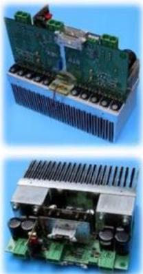
Als speisende Quelle stehen dem Messplatz am Institut entwickelte Verstärkermodule zur Verfügung, die eine Ausgangsspannung von bis zu 55V und einen Ausgangsstrom von bis zu 50A Spitze erzeugen können. Zur weiteren Steigerung der Leistung oder zum Betrieb von mehrphasigen Prüflingen lassen sich bis zu 2 Module im Verstärkergehäuse einbauen und parallel betreiben
